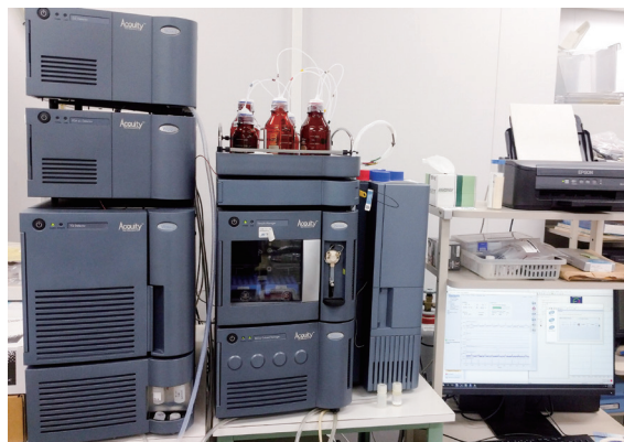
高速液体クロマトグラフィー質量分析システムでサンプルの分離と濃度測定をします。
