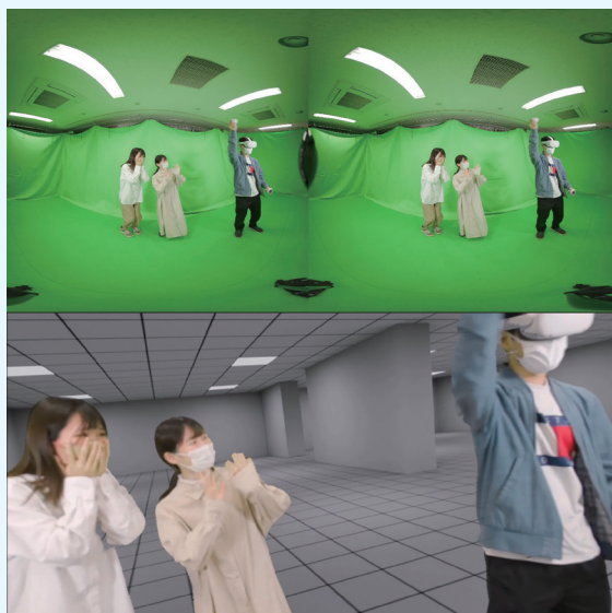
図1 (上) 視野180° 立体視グリーンバック撮影 (下) VR空間での立体映像の再生 撮影時に右目用と左目用の映像を同時撮影するので、VR空間では立体映像として再生される。
