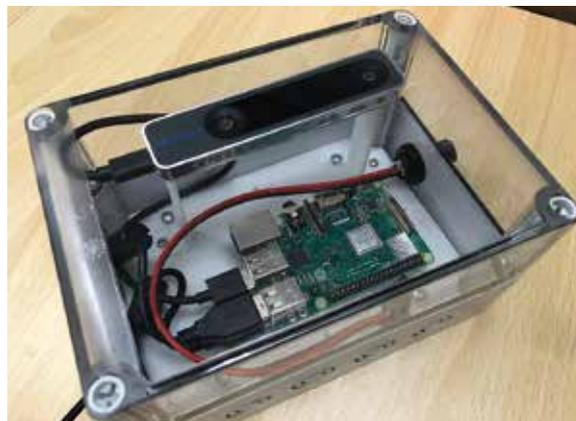
図2 イチゴ収穫台車に搭載する計測装置
