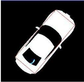
図 5 実車両の検出結果 (検出成功例)
